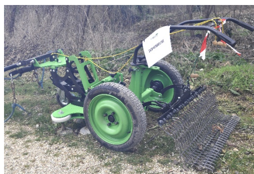
Figure 4. Exemples de matériel hippomobile exposé par la SMDA à Rueil-Malmaison (Hauts-de-Seine). À gauche, avant-train à relevage hydraulique électrique pour trois à quatre chevaux. À droite, desherbeuse de fabrication française pour un cheval. Photos Jean-Michel Besancenot (janvier 2022).
