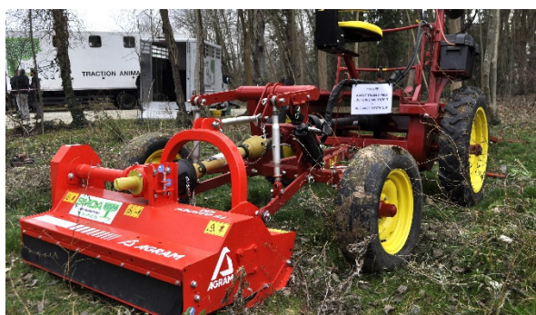
Figure 4. Exemples de matériel hippomobile exposé par la SMDA à Rueil-Malmaison (Hauts-de-Seine). À gauche, avant-train à relevage hydraulique électrique pour trois à quatre chevaux. À droite, desherbeuse de fabrication française pour un cheval. Photos Jean-Michel Besancenot (janvier 2022).
