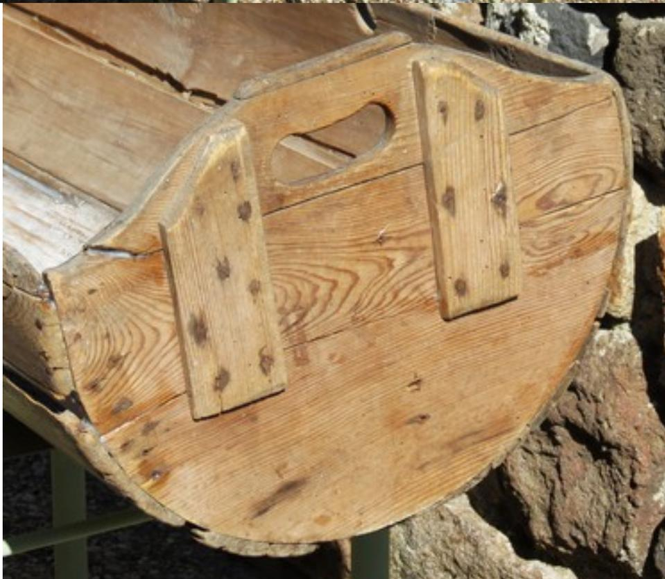
L'épaisseur des lames cintrées est de 9 mm. Celle des extrémités est de 15 mm. Il présente les traces de deux supports transversaux, d'environ 25 mm
